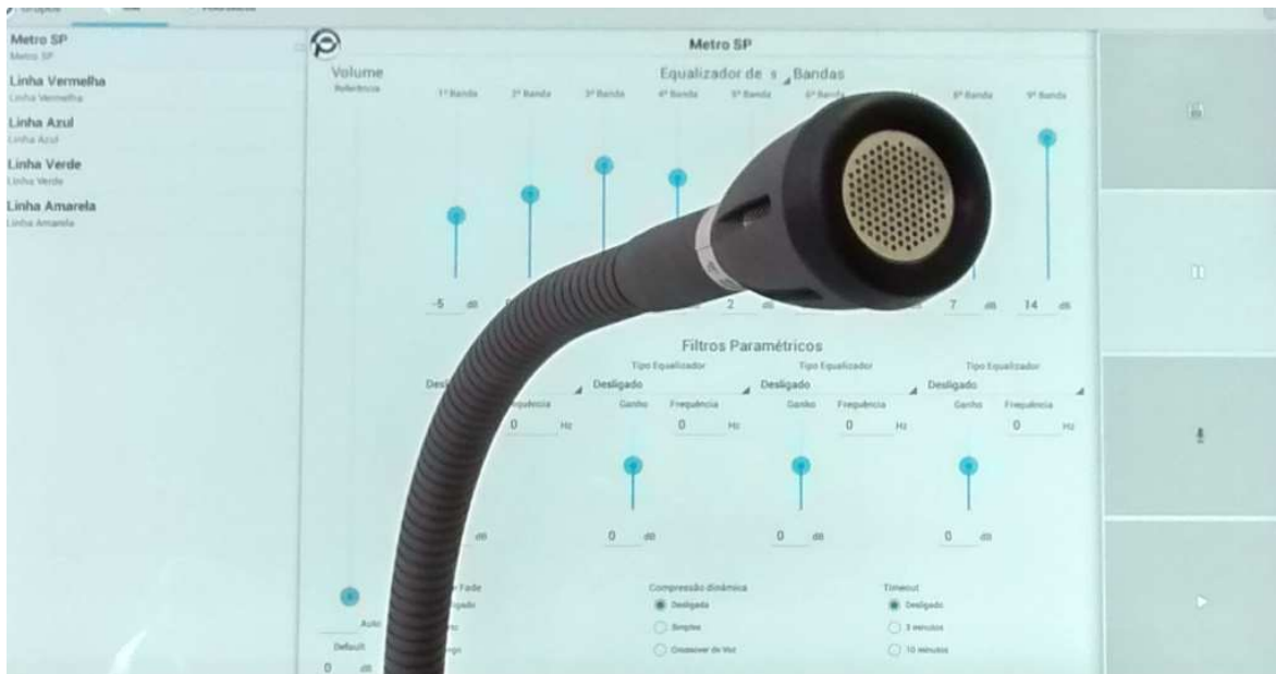
Microfone PG-05 operando integrado ao terminal de controle TCC-220
